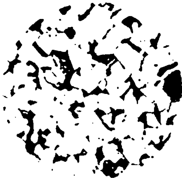
Рис. 3. Сегментированное изображение микроструктуры стали.
