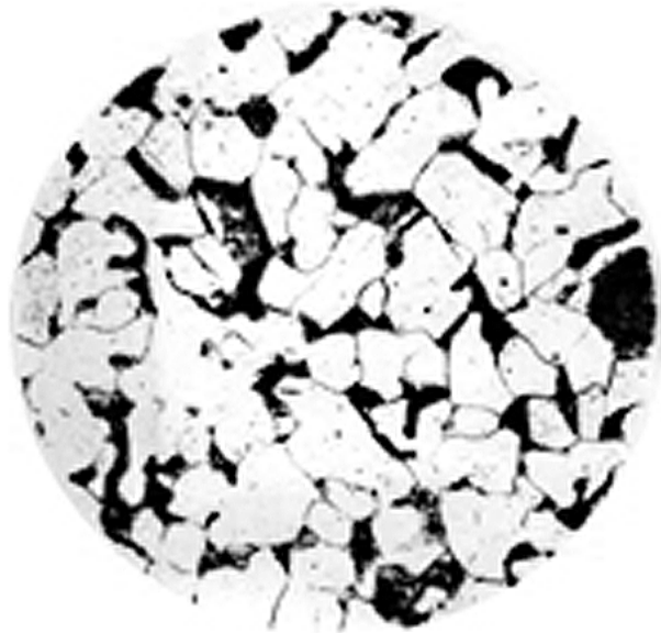
Рис. 2. Исследуемая микроструктура стали.
