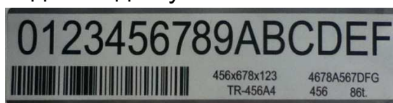
Рис. 1. Пример маркировки сляба
