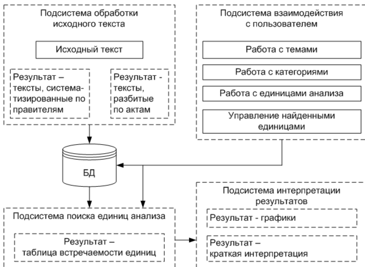
Рис. 2. Структурная схема системы компьютерного контент-анализа
