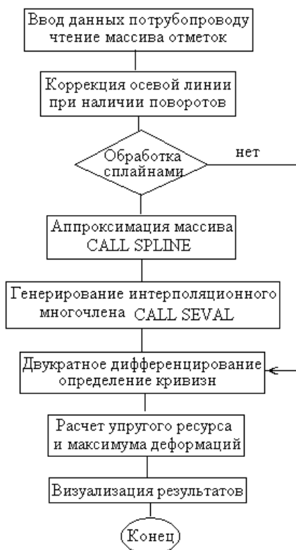
Рис. 7. Блок-хема программы STAIRS обработки рядов планово-высотных отметок сглаживанием кубическими сплайнами
