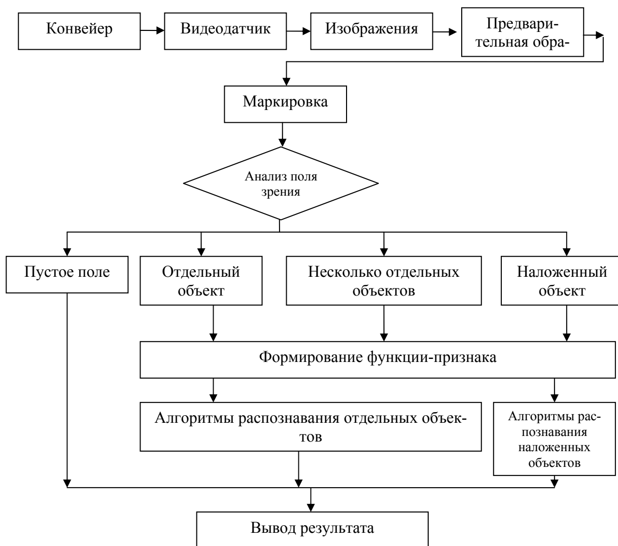
Рис. 1. Схема технологического процесса распознавания
