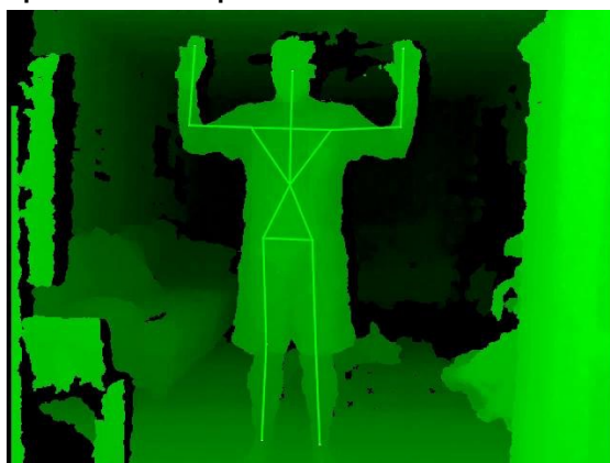
Рис. 2.Примеры результатов работы сенсора Kinect; Карта глубины и модель скелета человека.
