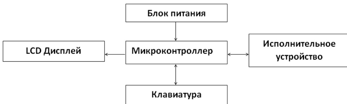
Рис. 1. Функциональная схема автоматизированной системы управления микроклиматом в аквариуме
