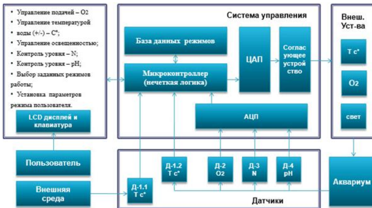
Рис. 2. Структурная схема автоматизированной системы управления микроклиматом в аквариуме
