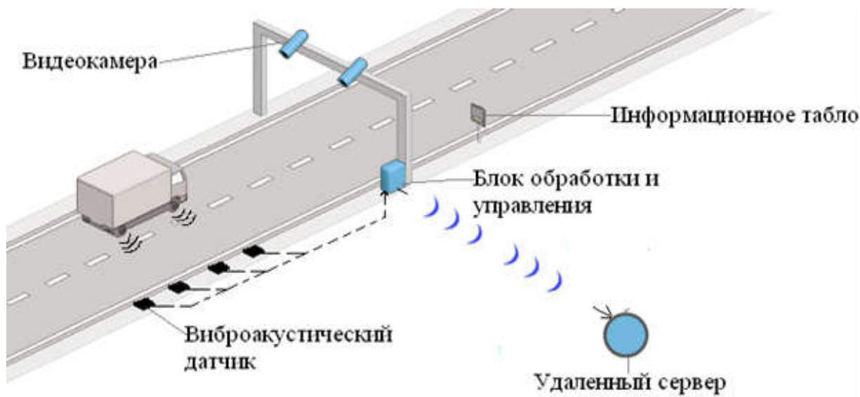
Рис.1. Реализация виброакустического метода идентификации параметров автомобиля.
