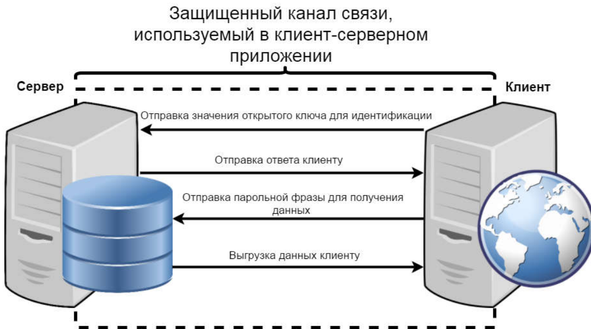
Рис. 1. Схема клиент-серверного приложения, использующего протокол рукопожатия
