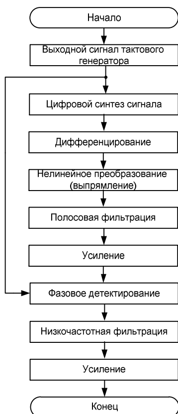
Рис. 3. Алгоритм и временные диаграммы формирования управляющего сигнала АКФИ ЦВС с детектированием на частоте, в два раза меньшей тактового сигнала.
