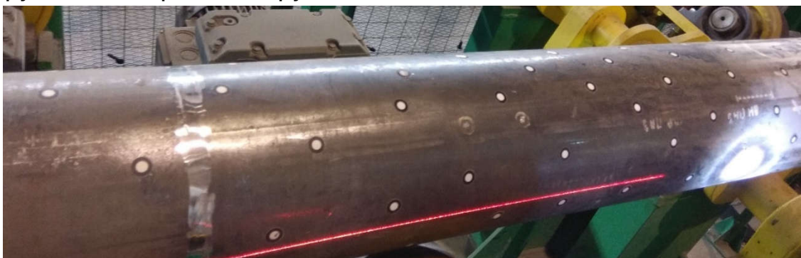
Рис. 2. Образец трубы с искусственными дефектами
