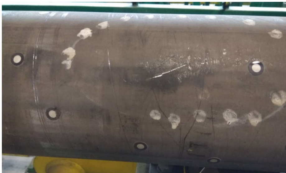
Рис. 3. Участок образца с дефектом типа «риска»
