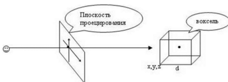
Рис. 5. Схема построения ортогональной проекции
