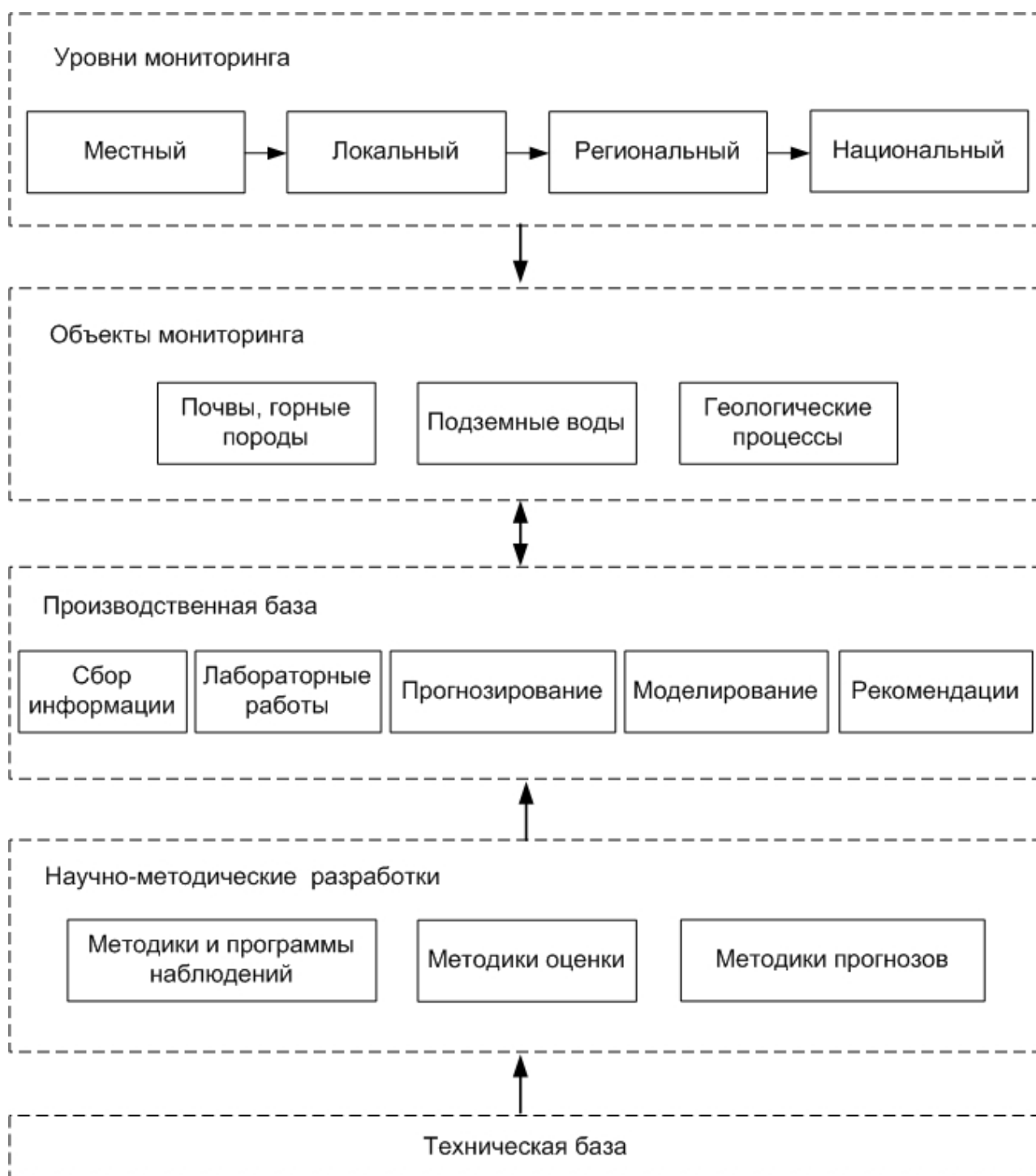
Рис. 1. Общая структура географической информационно-аналитической системы геодинамического мониторинга.
